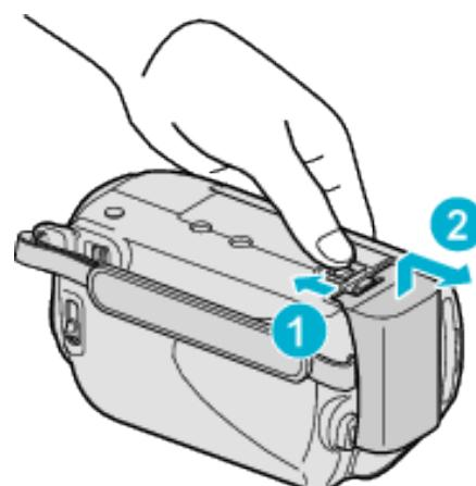
バッテリー取りはずしレバーをスライドさせて、バッテリーをはずしてください。
