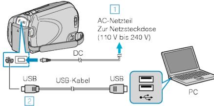
1 Schließen Sie das AC-Netzteil an das Gerät an.
