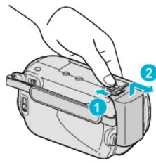
Betätigen Sie die Akkulösetaste, um den Akku vom Gerät abzunehmen.
