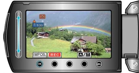
Imposta la velocità dell'otturatore da 1/2 a 1/4000. (fino a 1/1000 per i fermi immagine.)
