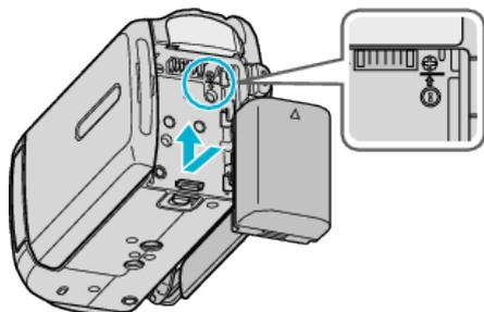
• Allineare la parte superiore della batteria con l'unità e farla scorrere fino a quando la batteria non scatta nel proprio alloggiamento.
