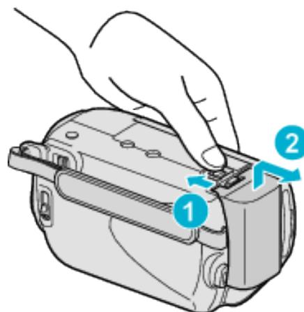
Posuňte tlačítkem pro odpojení baterie a baterii odejměte.
