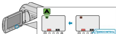
• Если установлен режим Ручной настройки, нажмите кнопку **A/M**. С каждым нажатием режим переключается с автоматического на ручной или наоборот.
