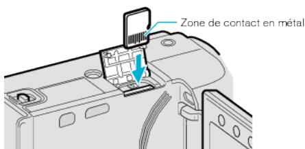
• Insérez avec le contact métallique tourné vers l'extérieur.
