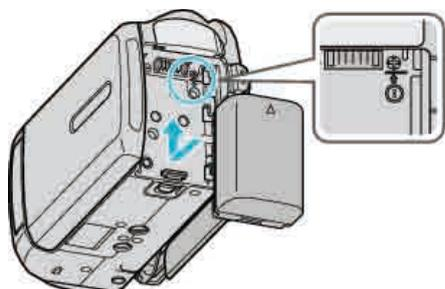
• Alinee la parte superior de la batería con esta unidad y deslícela hasta que se oiga un clic.
