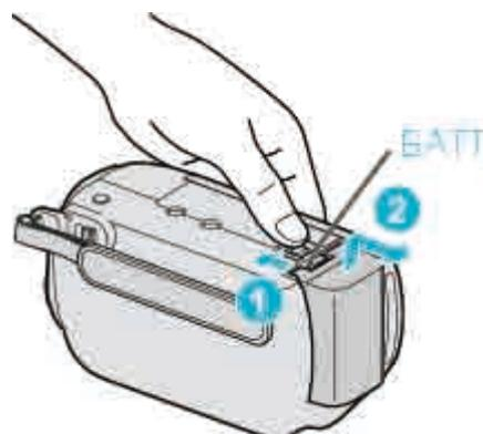
Deslice la palanca de liberación de la batería para extraer la batería de esta unidad.
