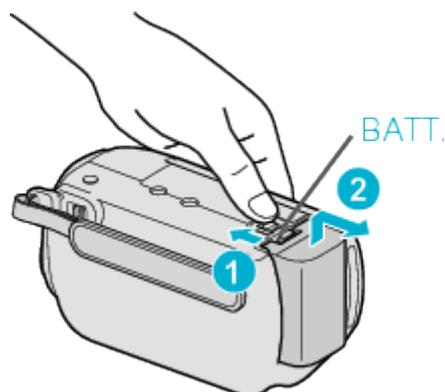
Deslice la palanca de liberación de la batería para extraer la batería de esta unidad.
