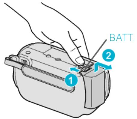
撥開電池釋放桿，將本裝置的電池拆下。
