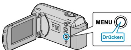
2 Wählen Sie mithilfe des ZOOM/SELECT-Reglers „BILD-STABILISIERUNG“ aus und drücken Sie OK.
