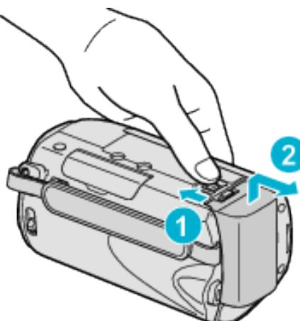
Подвиньте рычажок высвобождения батареи, чтобы снять аккумуляторный блок с аппарата.
