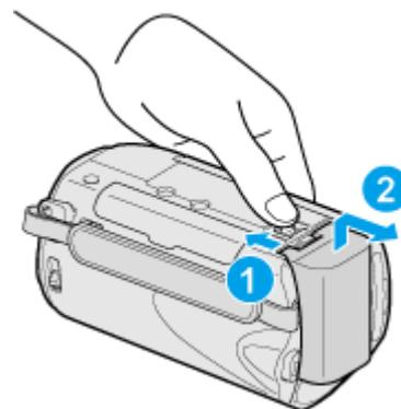
Deslice la palanca de liberación de la batería para extraer la batería de esta unidad.
