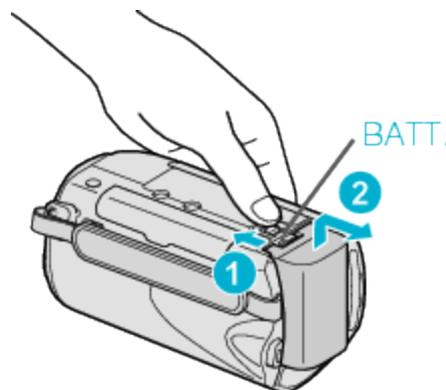
Подвиньте рычажок высвобождения батареи, чтобы снять аккумуляторный блок с аппарат.
