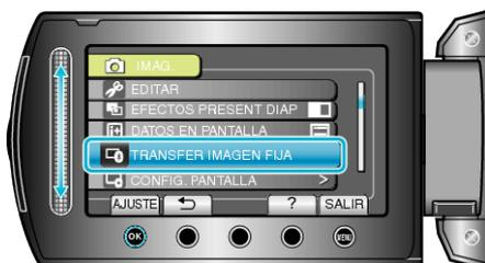
5 Establezca el dispositivo conectado en modo de recepción de datos.
