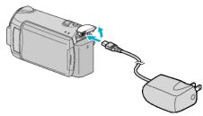
3 Verbinden Sie das Gerät mit dem Stromnetz.
