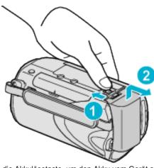
Betätigen Sie die Akkulösetaste, um den Akku vom Gerät abzunehmen.
