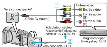
1 Raccordez l'appareil via le câble AV fourni.
