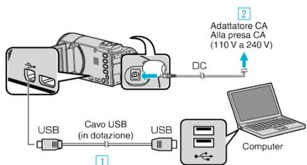
1 Eseguire il collegamento utilizzando il cavo USB in dotazione.
