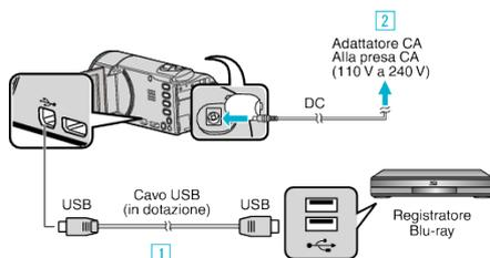
1 Eseguire il collegamento utilizzando il cavo USB in dotazione.
