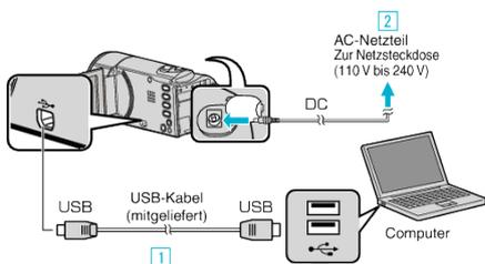
1 Verbinden Sie die Geräte mithilfe des mitgelieferten USB-Kabels.
