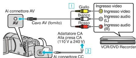
1 Eseguire il collegamento utilizzando il cavo AV in dotazione.
