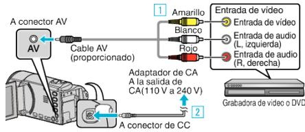
1 Realice la conexión utilizando el cable AV proporcionado.
