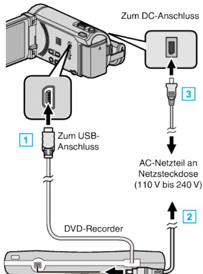
1 Verbinden Sie das USB-Kabel des DVD-Recorders mit diesem Gerät.
