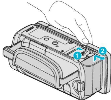
Подвиньте рычажок высвобождения батареи, чтобы снять аккумуляторный блок с аппарат.
