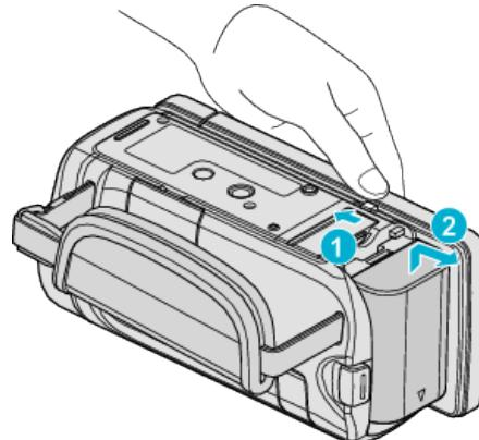
Подвиньте рычажок высвобождения батареи, чтобы снять аккумуляторный блок с аппарата.
