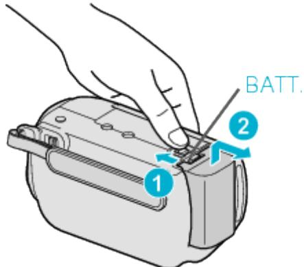
Подвиньте рычажок высвобождения батареи, чтобы снять аккумуляторный блок с аппарата.
