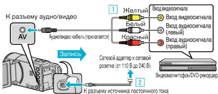
1 Подключите с помощью аудио/видео кабеля.
