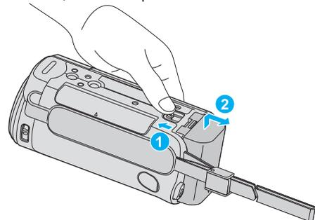
Deslice la palanca de liberación de la batería para extraer la batería de esta unidad.
