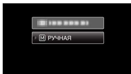
5 Отрегулируйте фокусировку с помощью кнопок UP/< и DOWN/>.
