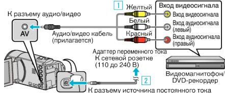
[1] Подключите с помощью аудио/видео кабеля.
