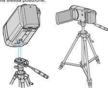
Per evitare di far cadere l'unità, controllare accuratamente i fori per le viti di montaggio del treppiede e i fori di posizionamento sulla unità prima del montaggio e serrare le viti finché non sono fissate saldamente.
