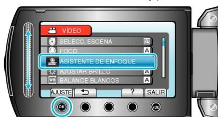
4 Ajuste el enfoque con el control deslizante.
