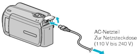
3 Verbinden Sie das Gerät mit dem Stromnetz.
