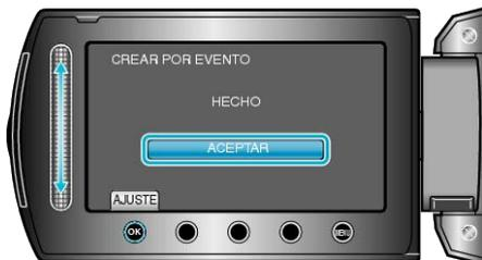
10 Cierre el monitor LCD y luego desconecte el cable USB.
