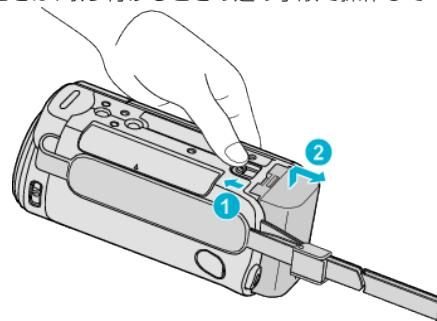
バッテリー取りはずしレバーをスライドさせて、バッテリーをはずしてください。
