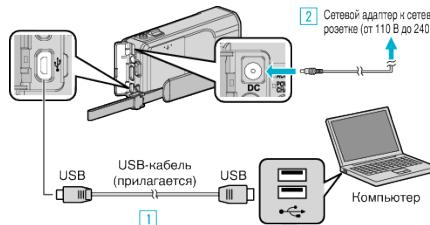
1 Подключите камеру к компьютеру с помощью USB-кабеля.
