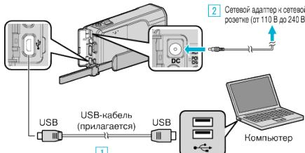
[1] Подключите камеру к компьютеру с помощью USB-кабеля.
