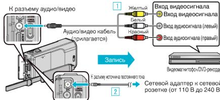
[1] Подключите с помощью аудио/видео кабеля.
