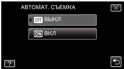
**7** Съемка начинается автоматически, когда объект внутри красной рамки, расположенной в центре экрана, движется.
