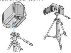
● 落下を防ぐために、取り付け前に本機側の三脚取り付け用のネジ穴と、位 置決め穴の位置をよく確認し、ネジを回してしっかりと取り付けてくだ さい。
