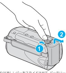
バッテリー取りはずしレバーをスライドさせて、バッテリーをはずしてく ださい。
