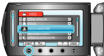
4 Passen Sie den Fokus mithilfe des Touch-Sensors an.
