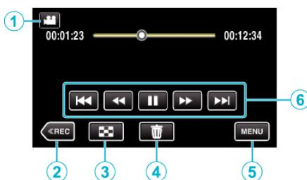
● 本機の操作を約5秒間行わないと、タッチパネルの操作ボタンが消えます。もう一度表示させるには、画面をタッチしてください。
