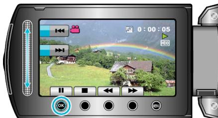
• Após pausar o vídeo, você pode sintonizar precisamente o ponto a ser capturado utilizando os botões de operação de reprodução com avanço **▶** e retrocesso em câmera lenta **◀◀**.
