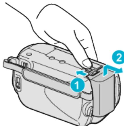
Faites coulisser le levier de dégagement de la batterie pour la détacher de l'appareil.
