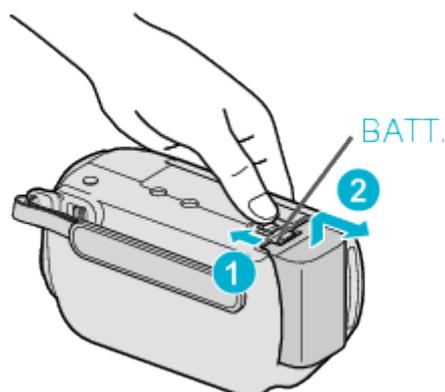
Faites coulisser le levier de dégagement de la batterie pour la détacher de l'appareil.
