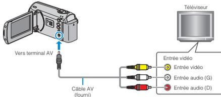
4 Appuyez sur la touche d'entrée externe du téléviseur pour commuter vers l'entrée de cet appareil, par le terminal raccordé.
