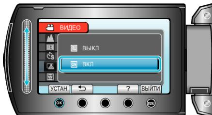
**6** Съемка начинается автоматически, когда объект внутри красной рамки, расположенной в центре экрана, двигается.
