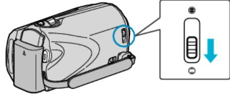
2 افتح شاشة LCD وقم باختيار وضع التشغيل.
