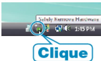
**2** Clique em "Remover com segurança o Dispositivo USB de armazenamento em massa" (Remover dispositivo de armazenamento USB com segurança).
