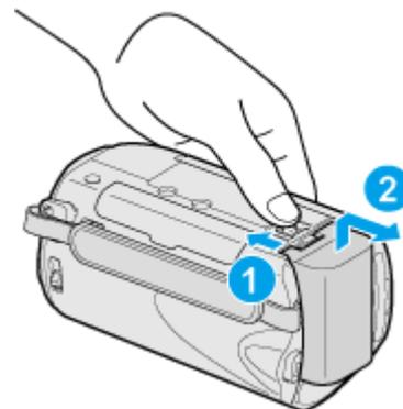
Подвиньте рычажок высвобождения батареи, чтобы снять аккумуляторный блок с аппарат.
