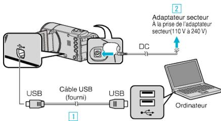
1 Raccordez l'appareil via le câble USB fourni.
