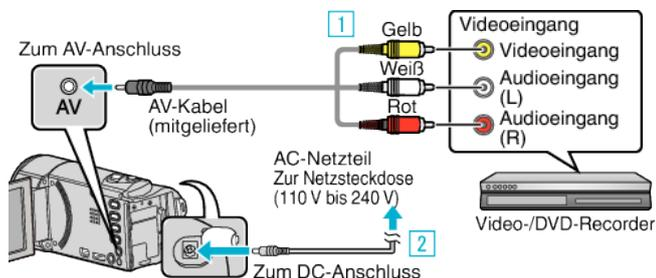
1 Verbinden Sie die Geräte mithilfe des mitgelieferten AV-Kabels.
