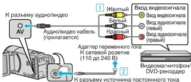
1 Подключите с помощью аудио/видео кабеля.
