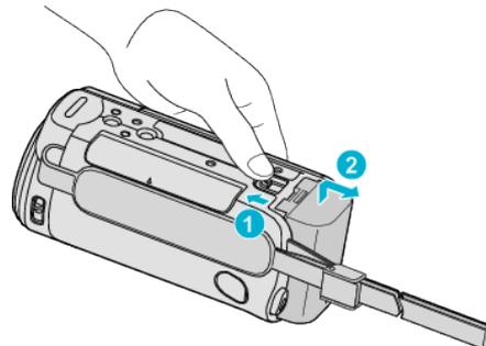
Faites coulisser le levier de dégagement de la batterie pour la détacher de l'appareil.
